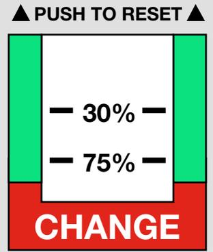
Así mismo los elementos para su optimización como, los indicadores de restricción, que miden la restricción o vacío y ayudando maximizar la vida del filtro, a prevenir el uso excesivo de combustible causado por filtros sobre restrictivos y a disminuir el costo operacional del vehículo.
